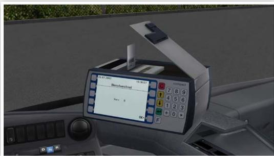
Wenn der Fahrscheindrucker hochgefahren ist, öffnen Sie zuerst den Deckel oben und stecken die Modulkarte ein. Dadurch wird der Fahrscheinverkauf freigeschaltet. Der Drucker sollte nun „Betriebsbereit“ anzeigen.
