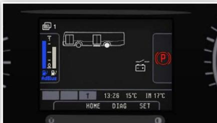
Für diese Busgeneration hat der Hersteller einen neuen Fahrerplatz gestaltet, der auf dem gewohnten VDV-Standard basiert. Enthalten ist auch wieder ein Infodisplay, das viele Rundanzeiger ersetzt, jedoch wurde dieses neu entwickelt und etwas kleiner gestaltet. Im Vergleich zum alten VDV-Cockpit hat man wieder etwas traditionelle Kontrollleuchten für die wichtigsten Funktionen eingebaut und vertraut nicht mehr so sehr auf das Display.
