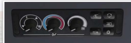
Bedient wird die Klimatisierung mit dem Bedienteil im Sägezahn über dem Fahrerplatz.
